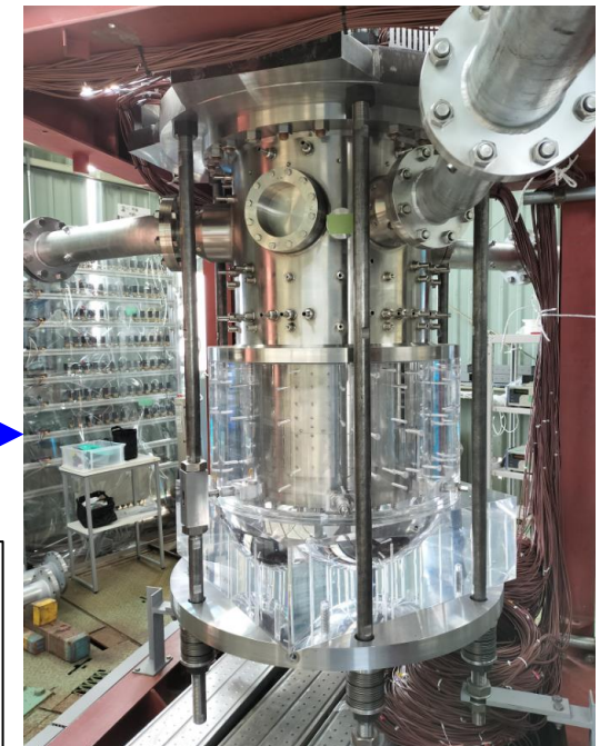
下部流動試験のスケールモックアップ （左図の青色領域が対象）
